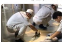
车底焊缝密封
